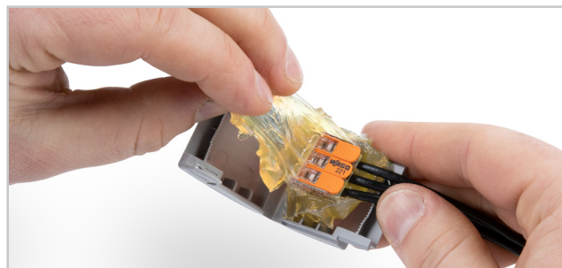
Kringen uitbreiden: Open de gelbox, verwijder de gel uit de terminal, open de terminal en monteer de kabel met nieuwe componenten.
