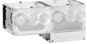
Les boîtes REDDY sont dotées de 12 entrées défonçables de diamètre 20 mm dont 6 avec épaulement, et 2 grandes entrées latérales en profondeur 65 mm.
