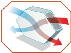
L'échangeur à plaques en matière synthétique à contre-courant empêche l'air sale et l'air propre d'entrer en contact. Les bactéries n'ont ainsi aucune chance.
