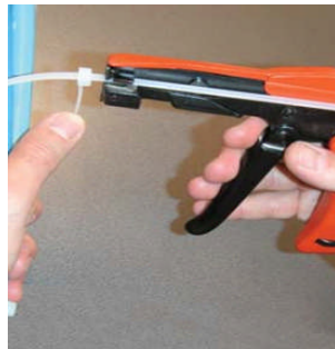
Kabelbinder met spantang vastnemen
