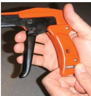
Kabelbindertang op juiste diameter en spanning afstellen.
